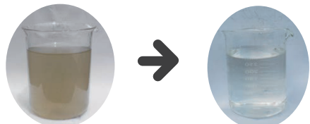
下水処理場に入ってきた水 下水処理場から出ていく水
